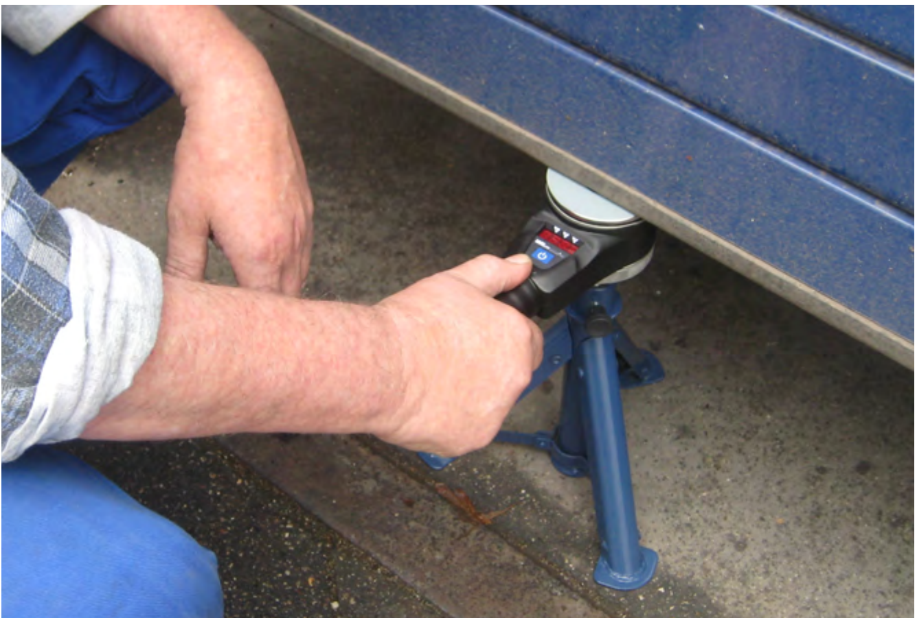
Abb. 25 Schließkraftmessung an der Hauptschließkante eines Torflügels
