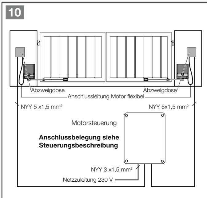
Der Motoranschluss und die Endschalter (Öffnerkontakte) sind schon vorverdrahtet und auf einer Klemmleiste angeschlossen. Die Zuleitung muss am Antrieb und an der Steuerung angeschlossen werden.
