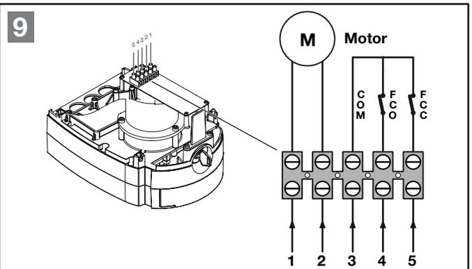
Anschluss an der Motorsteuerung MS1024
