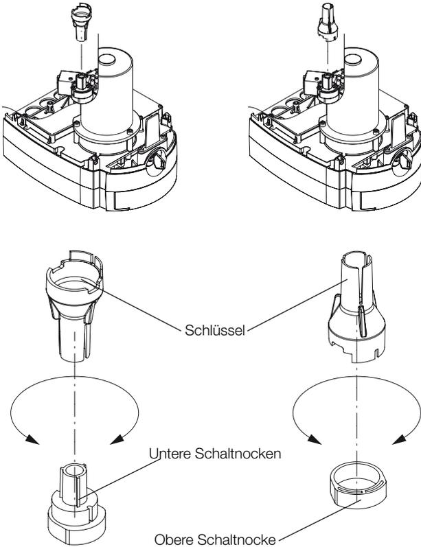
**Einstellen der Endlage Tor-Zu:** Das Tor in die gewünschte Tor-Zu-Position bewegen. Den unteren Einstellring, mit Hilfe des beiliegenden Einstellschlüssels, soweit drehen, bis der Endschalter betätigt wird. Abschließend den Einstellring mit der mittleren Feststellschraube gegen Verdrehen sichern.
