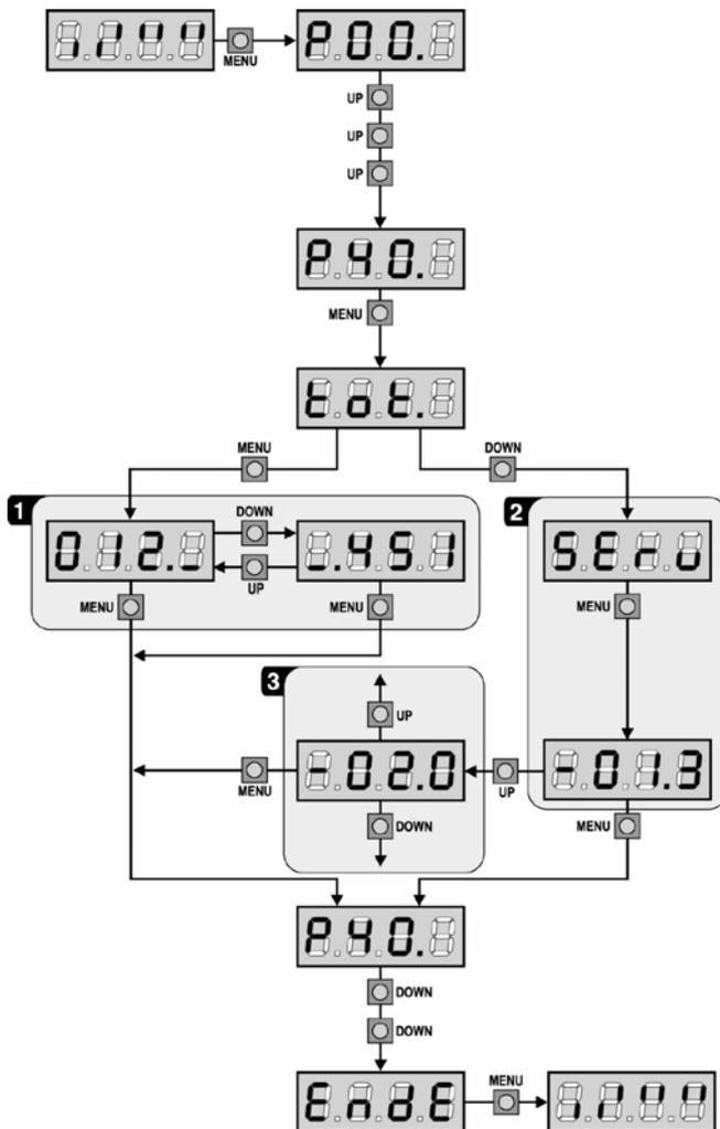
Im oben dargestellten Schema wird das Ablesen der bisherigen Zyklen, der noch verbleibenden Zyklen bis zur Wartung und das Einstellen des neuen Wartungsintervalls gezeigt.
